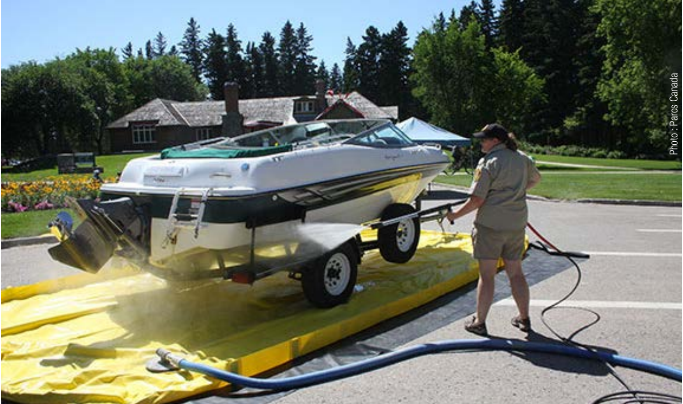
Utilisation d'une membrane de récupération d'eau de nettoyage à une station de décontamination d'embarcation.
